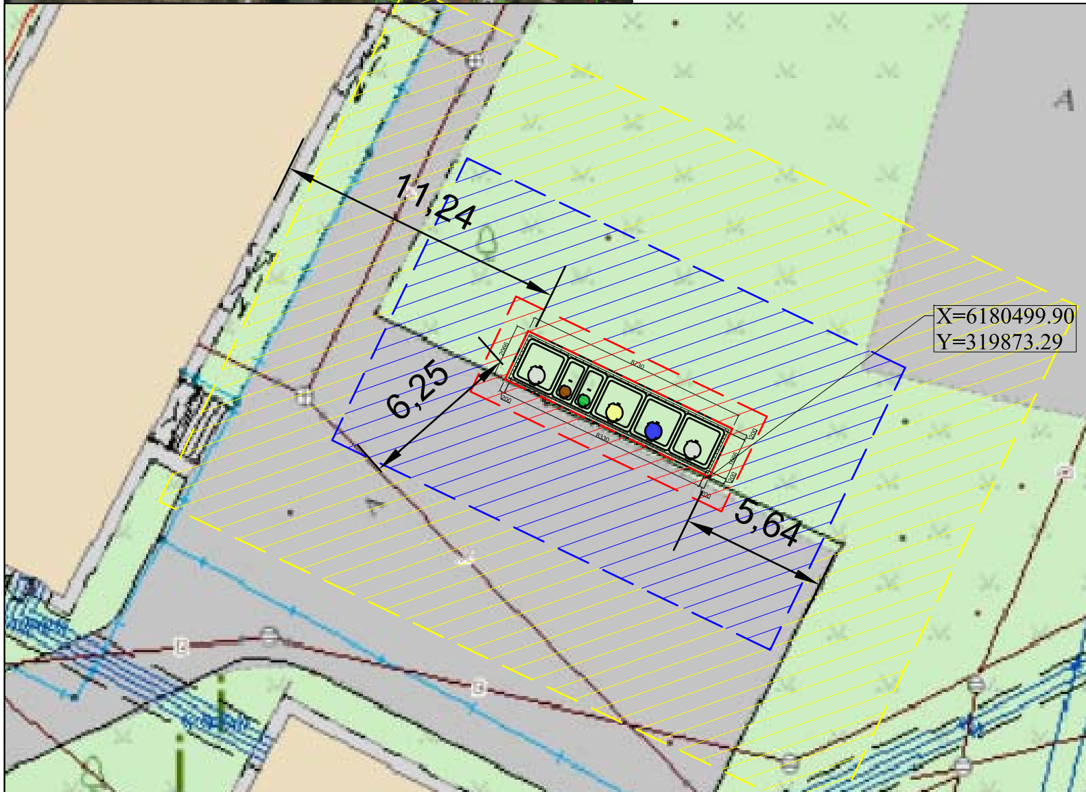
PUSIAU POŽEMINIŲ KONTEINERIŲ AIKŠTELĖS ĮRENGIMO SCHEMA M 1:200
