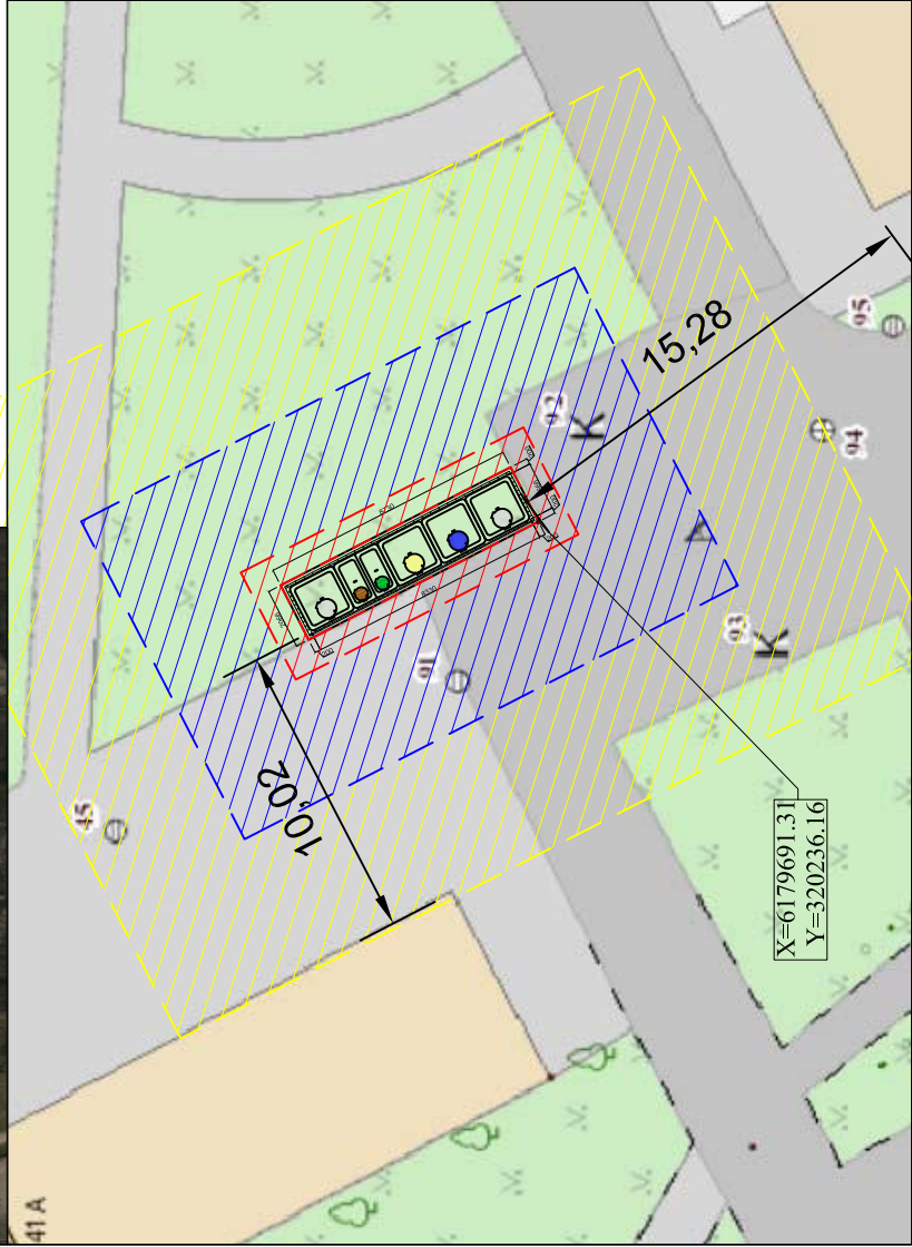
PUSIAU POŽEMINIŲ KONTEINERIŲ AIKŠTELĖS ĮRENGIMO SCHEMA M 1:200
