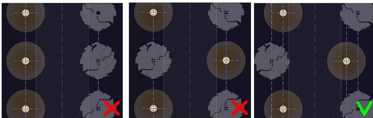
Pav.4.7. Šviestuvų montavimo prie gatvių rekomendacijos. 1 - neardyti gatvių simetrijos; 2 - nerikiuoti šviestuvų ir medžių į „tvoras“; 3 – apšvietimą ir želdinimą komponuoti pražangiai.
