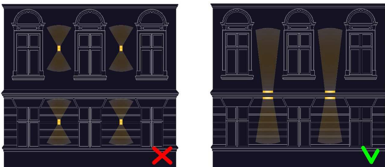
Pav.4.8. Šviestuvų montavimo prie fasado rekomendacijos. 1 - neardyti pastatų architektūros; 2 - prožektorius maskuoti architektūrinėse detalėse.
