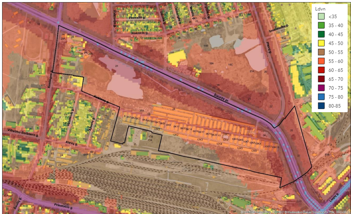
4.1 pav. Automobilių transporto sąlygojama akustinė būklė pagal Ldvn triukšmo rodiklį (https://www.geoportal.lt/map/ , žemėlapis paieškos kelias: viešosios paslaugos/savivaldybių duomenys/klaipėdos miesto savivaldybė/ klaipėdos miesto triukšmo žemėlapiai/)
