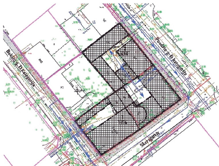
2 pav. Gaisro gesinimo ir gelbėjimo automobiliams privažiuoti prie statinių išdėstymo schema
