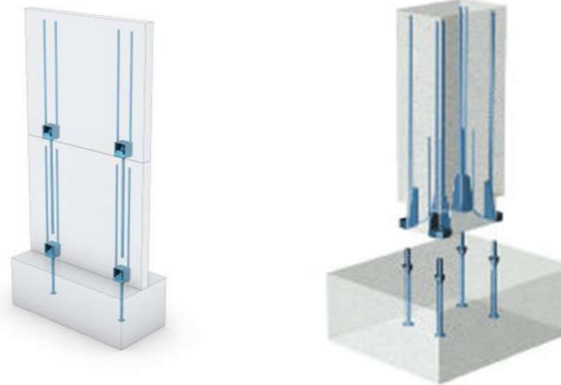
Surenkamo gelžbetonio kolonų ir sienų montavimo principas
