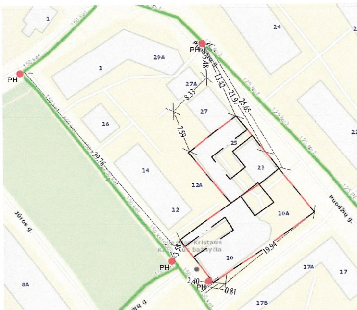
1 pav. Hidrantų išdėstymo schema ir atstumai iki planuojamų pastatų
