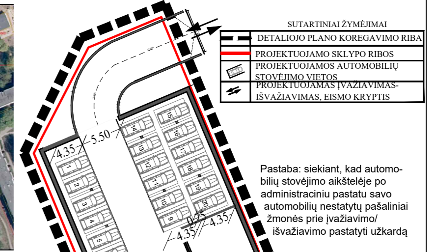
POŽEMINĖS AUTOMOBILIŲ STOVĖJIMO AIKŠTELĖS SCHEMA M 1:500
