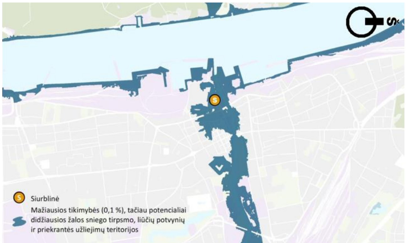
9 pav. Buitinių nuotekų siurblinės NS-2 vieta sniego tirpsmo, liūčių potvynių ir priekrantės užliejimų teritorijų atžvilgiu
