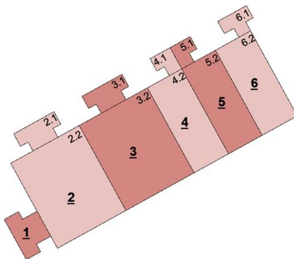
5 pav. Šešių blokuotų gamybos paskirties pastatų dalinimo į statybos etapus schema
