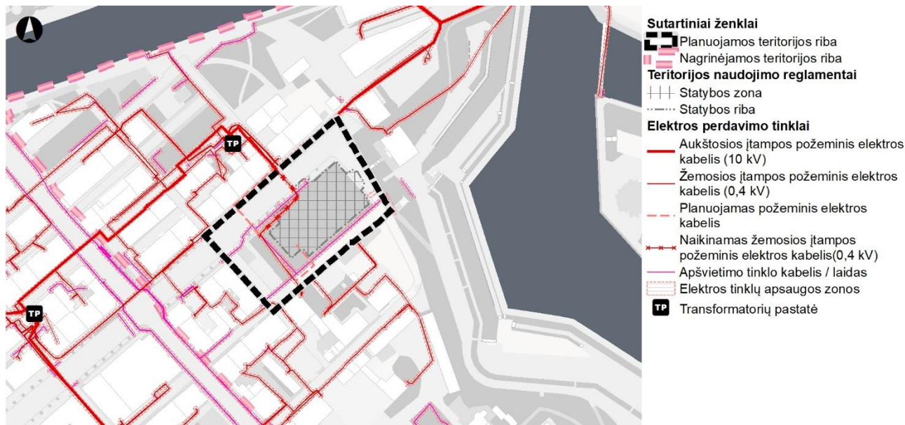
6.2 pav. Esami, planuojami ir naikinami elektros tinklai
