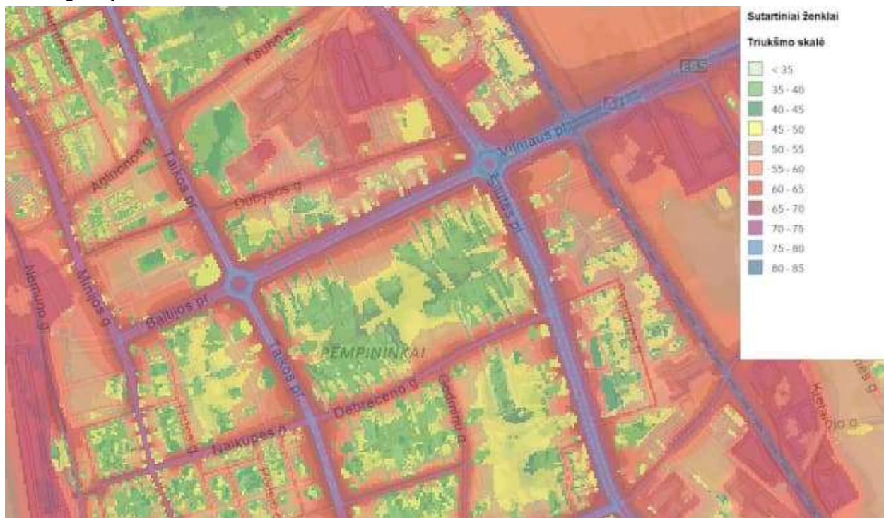
5.2.2 pav. Suminis (kelių transporto, geležinkelio transporto ir pramoninės veiklos) strateginis triukšmo žemėlapis
