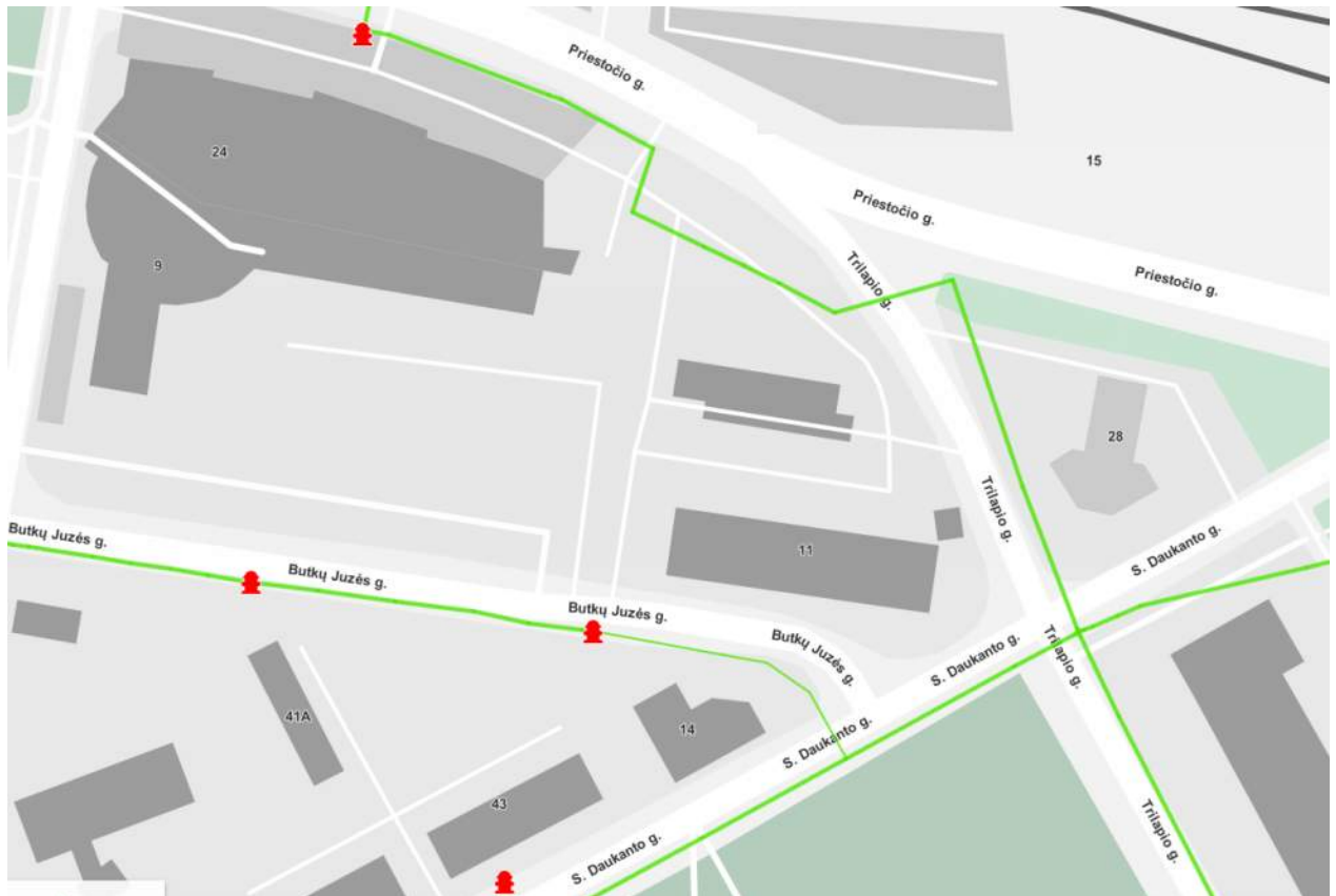
Pav. Arčiausiai esančių gaisrinių hidrantų ir vandentiekio šulinių žemėlapis (schema).
