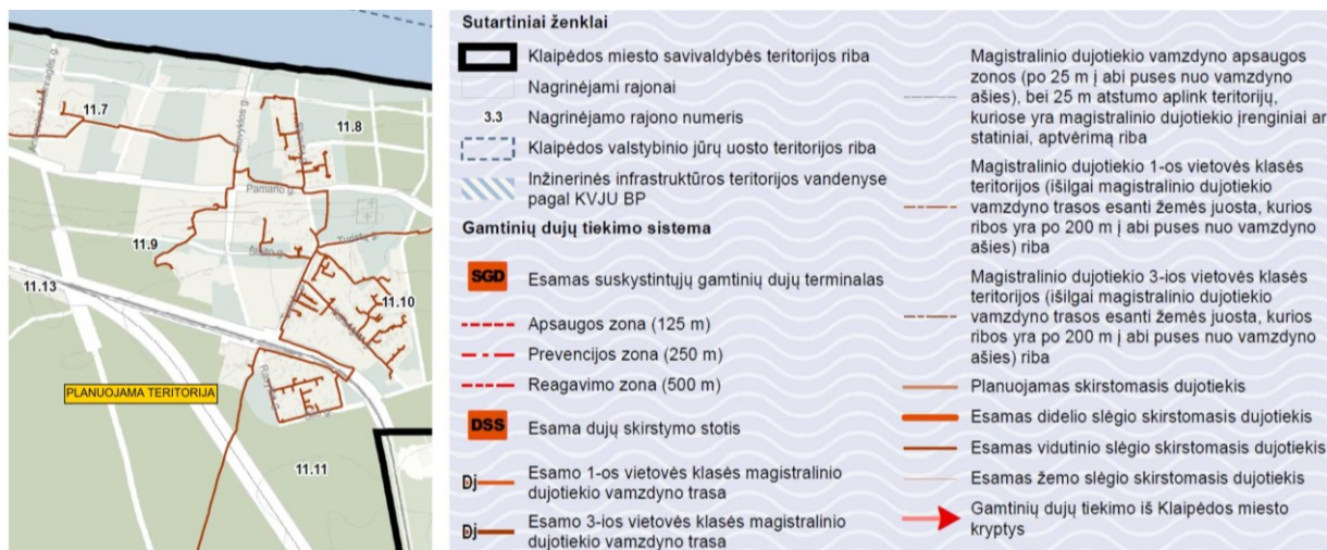
22 pav. Klaipėdos bendrojo plano dujų tiekimo sistemos brėžinio ir reglamentų (BP) ištrauka
