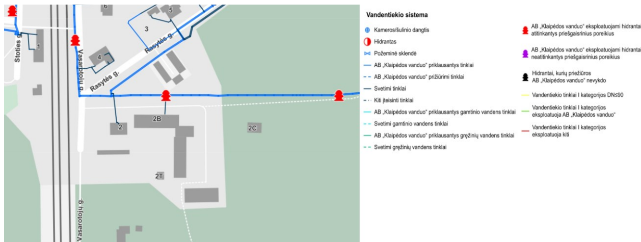
30 pav. Klaipėdos miesto ir rajono hidrantų išdėstymo schemos ištrauka
