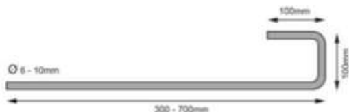
5.5 pav. Tinklo tvirtinimo smeigė
