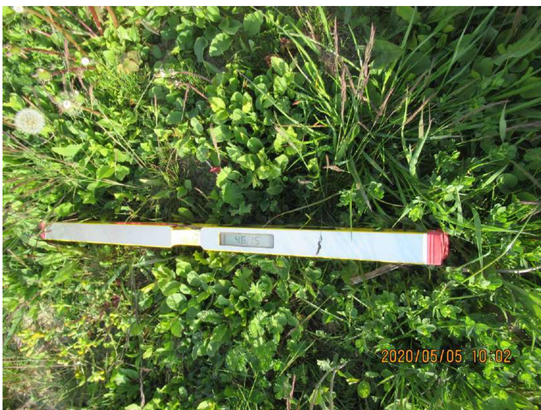
Nuotrauka Nr. 8. Šlaito nuolydis išmatuotas elektroniniu gulsčiu iki 46°.
