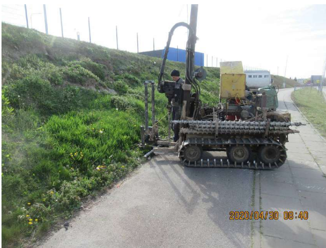
Nuotrauka Nr. 6. Inžineriniai geologiniai tyrimai šlaito apačioje.
